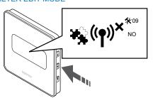
Press  $\mathbf{OK}$  to enter parameter edit mode (the parameter starts flashing).
