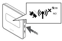
Press  $\mathbf{OK}$  to enter parameter edit mode (the parameter starts flashing).
