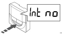
Press **OK** to enter parameter edit mode (the parameter starts flashing).
